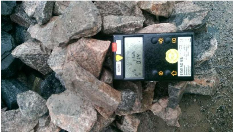
Abbildung 6: Messung der Ortsdosisleistung an kristallinem Schotter, wie er allgemein als Füllung für Gabionen, oder in Vorgärten verwendet wird (Messwert 0,14  $\mu\text{Sv/h}$ )
