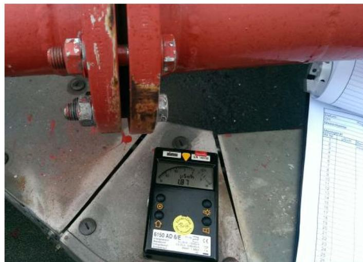
Abbildung 2: vom Verantwortlichen am 10. März ermittelte Ortsdosisleistung im Bereich der Thermalwasserleitung
